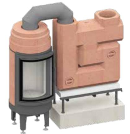
**Die technischen Daten sprechen dabei für sich:** Mit einer Dichte von 2,75 kg/dm<sup>3</sup> und einem Wärmeleitkoeffizienten von 2,62 W/m\*K bietet das Speichersystem höhere Werte im Vergleich zu Schamotte. Aufgrund der hohen Dichte ist eine äußerst kompakte Bauweise möglich und das Speichersystem benötigt dadurch wenig Platz im Aufstellraum.
