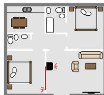
BIS ZU 8 METER WARMLUFTKANALISATION über 1 Ausgang hinten Ø80 (ausschließbar)
