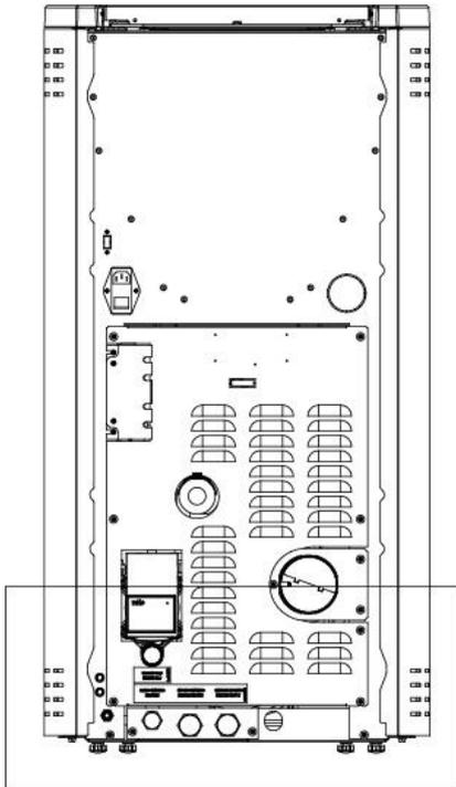
A1 = Wasservorlauf Heizung 3/4" M
