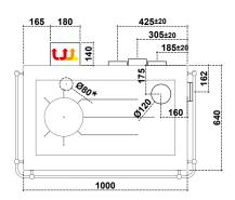
\* Anschluss für externe Verbrennungsluft
