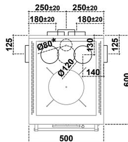
\* Anschluss für externe Verbrennungsluft
