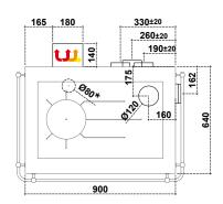
\* Anschluss für externe Verbrennungsluft
