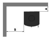
Mit Rücksicht auf Wärmezirkulation, Reinigung und evtl. Säuberung des Ofens von innen, sollte der Abstand zum Mauerwerk 20 cm betragen. Eine Schicht Tapete wird normalerweise, wenn sie auf Mauerwerk angebracht ist, nicht als brennbares Material angesehen.
